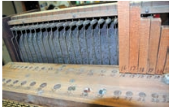
Stiftwalze für acht Lieder, Abstastmechanik (Clavis) Windlade für 42 Flöten mit den Flöten Nr. 16 bis 21.
