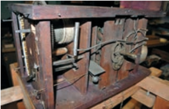
Ansicht ohne Uhrenschild. Gewichtsantrieb über Seilrolle.
