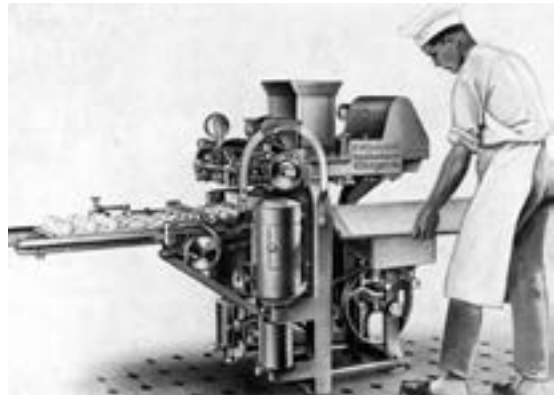
Abb. 3: Vollautomatische Brötchenteigteil- und Rundwirkmaschine „Derby“, Modell 1925. Winkler-Werkszeitung 1, 1963.
